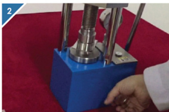
2 顺时针拧紧压片机放油阀
